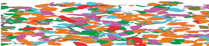
Abb. 11 Beispieldaten des NIR-Sensors aus der Anlage. Die unterschiedlichen Farben stellen die verschiedenen Materialien dar
